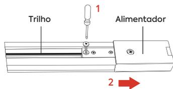
2. Abra o alimentador para realizar a ligação elétrica, retirando o parafuso indicado da tampa.
